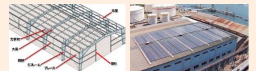
システム建築のフレームシステム
